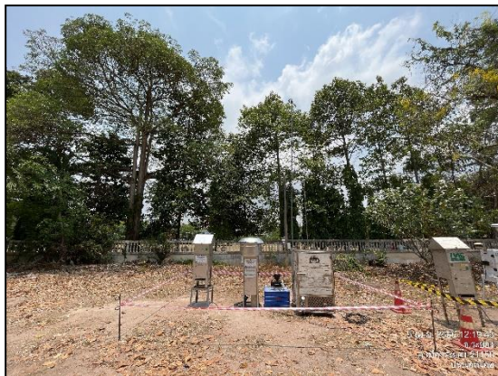
รูปที่ 4.1 การเก็บตัวอย่างคุณภาพอากาศในบรรยากาศ บริเวณ วัดมาบชูด
