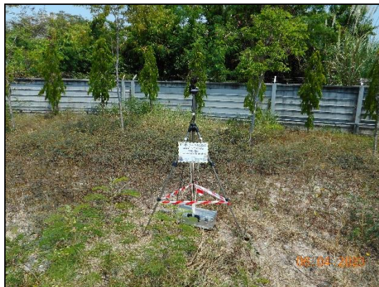
รูปที่ 4.6 การตรวจวัดระดับเสียงริมรั้วโรงงาน บริเวณ ริมรั้วโรงงานด้านทิศตะวันตก
